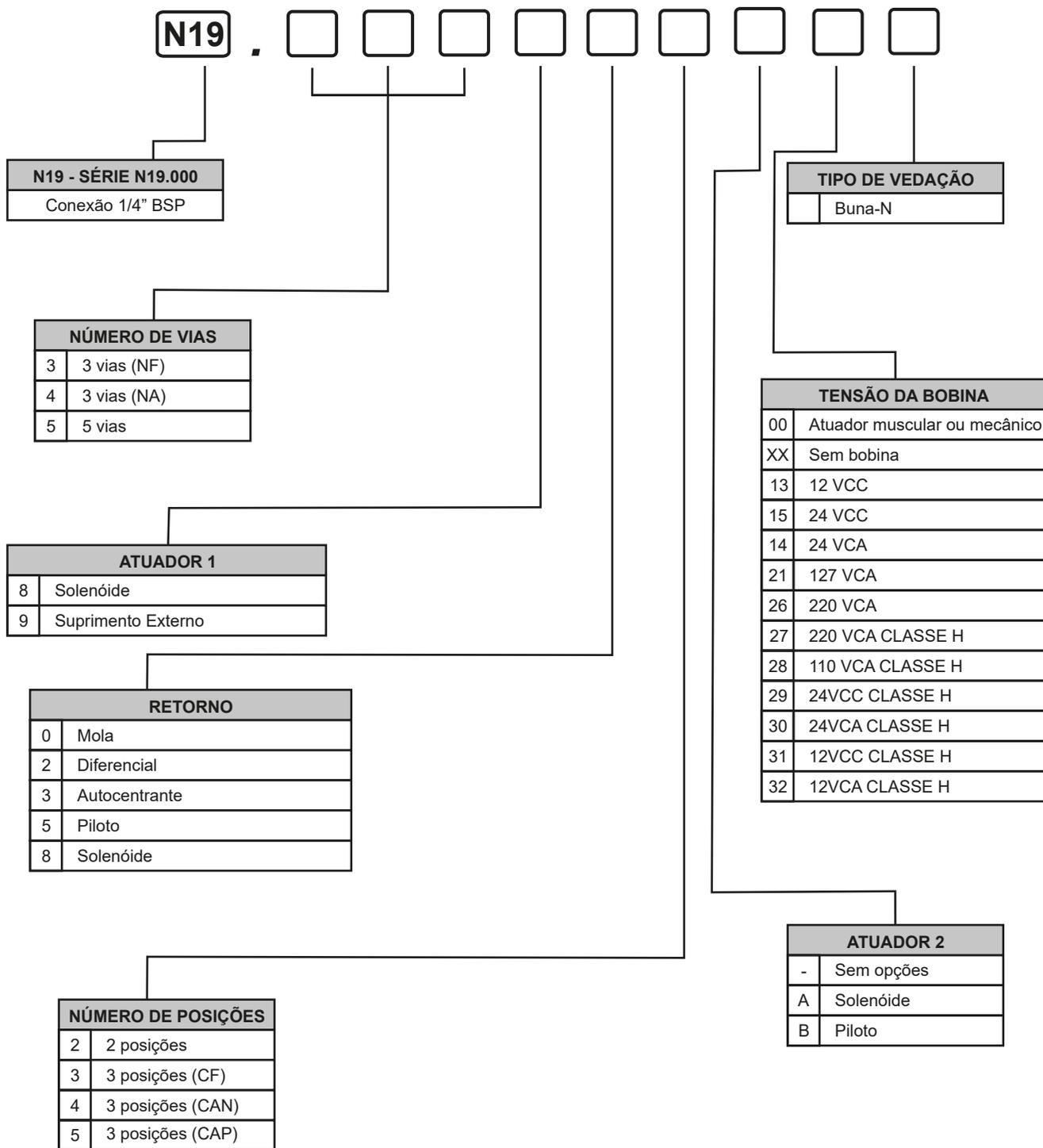
\* Não existem válvulas 3/3 autocentrante CAN e CAP, somente 3/3 autocentrante CF.
