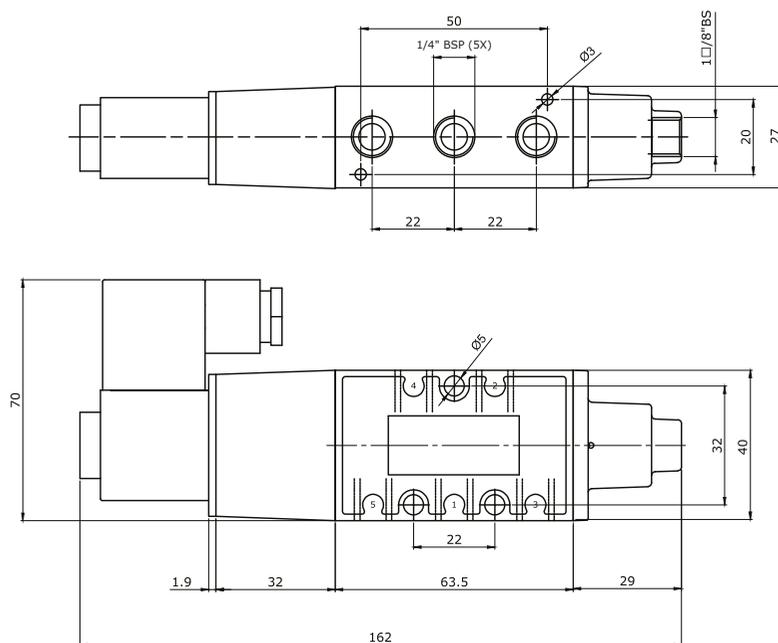
Válvula Alavanca Lateral Autocentrante - 3 Posições - 5/3 vias (CF) - Ref.: N18.5A33B00
