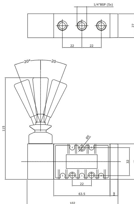
Válvula Alavanca Lateral Autocentrante - 3 Posições - 5/3 vias (CF) - Ref.: 20.5A33B00
