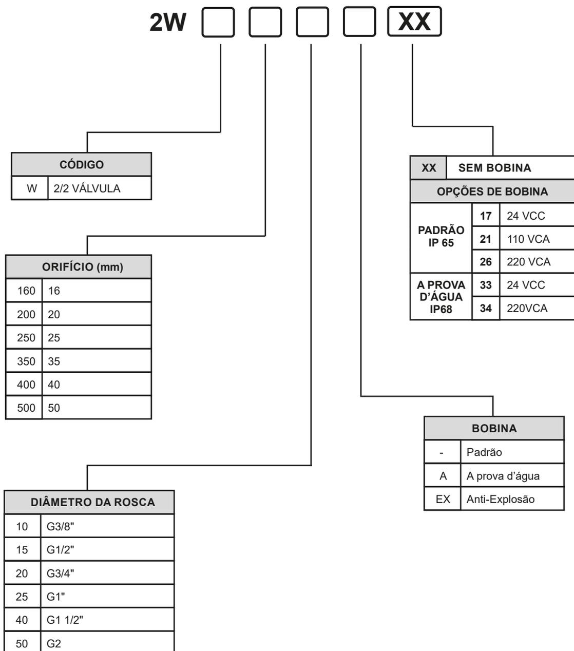
Obs.: opção de bobina IP68 não oferece combinação com anti-explosão.
