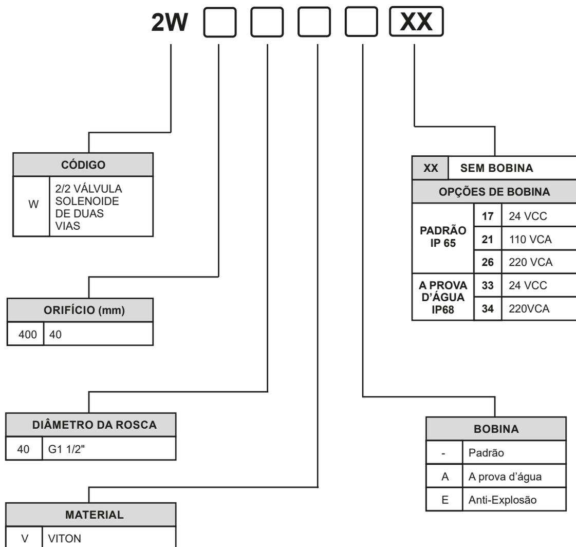
Obs.1: opção de bobina IP68 não oferece combinação com anti-explosão.
