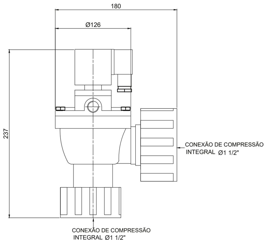
**Nota:** O tubo a ser usado no acoplamento destas válvulas devem ser, conforme as Normas DIN 2440 e NBR 5580 (normas para Tubos Pretos e Galvanizados), a saber: Diâmetro Externo do Tubo = 48,3 mm.
