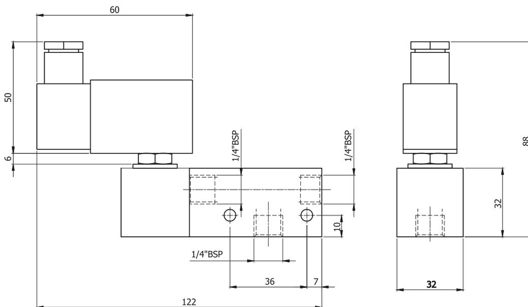
V-112S - Geradora de Vácuo com Solenóide 3/4" BSP
