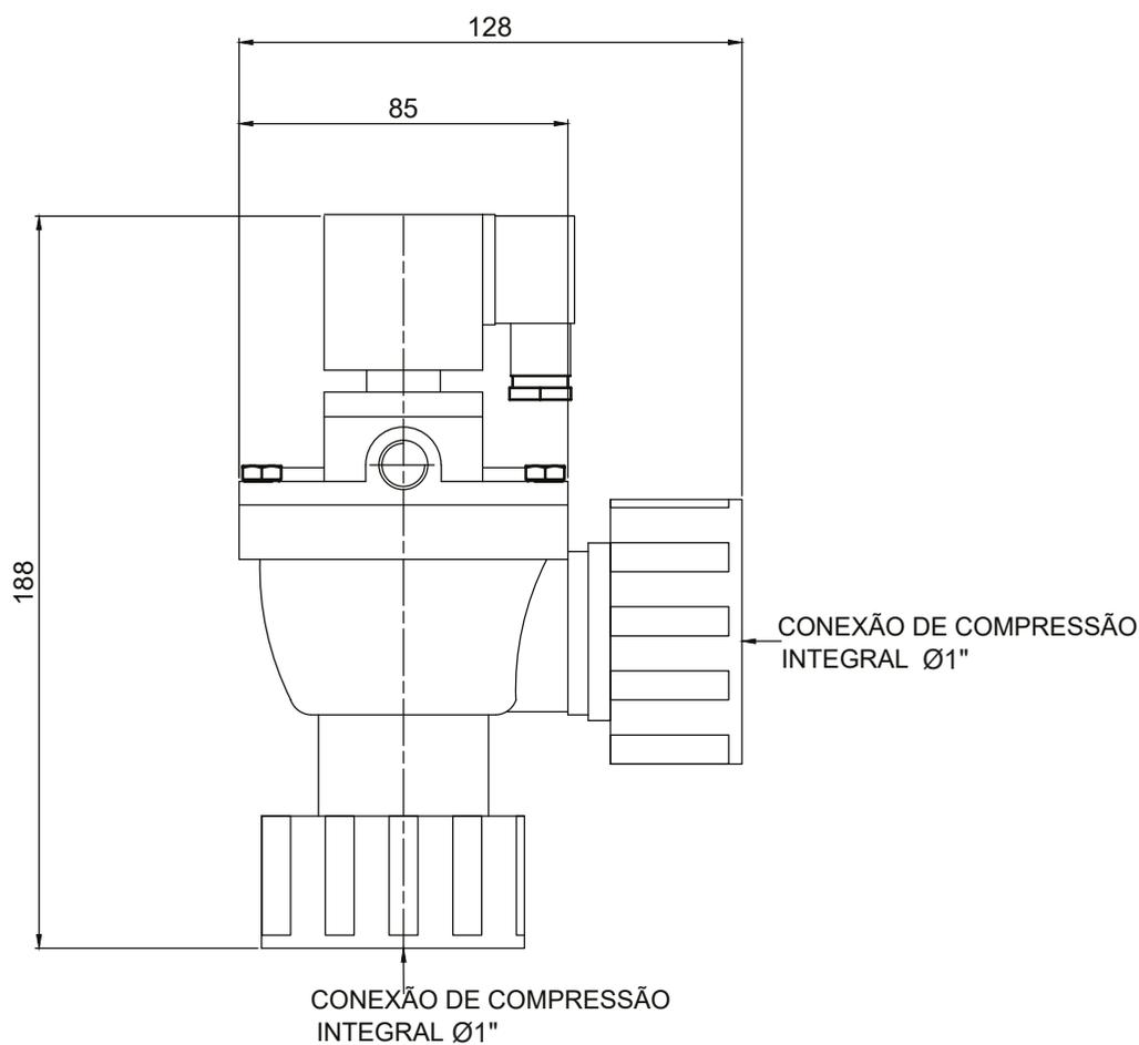
**Nota:** O tubo a ser usado no acoplamento destas válvulas devem ser, conforme as Normas: DIN 2440 e NBR 5580 (normas para Tubos retos e Galvanizados), a saber: Diâmetro Externo do Tubo = 33,7 m.
