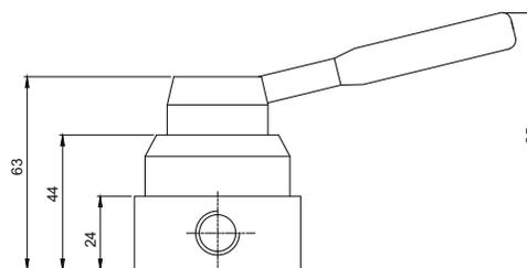
Válvula Alavanca Rotativa Lateral de 1/4" - Acionamento Cerâmica - HV1-14L11
