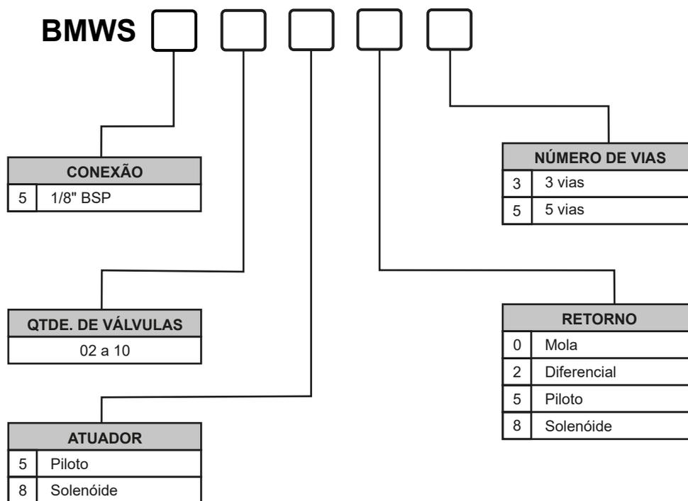
Quando o pedido for de 2 modelos de válvulas no mesmo bloco, codifique o segundo modelo e substitua o BMW S por BMWSD.
