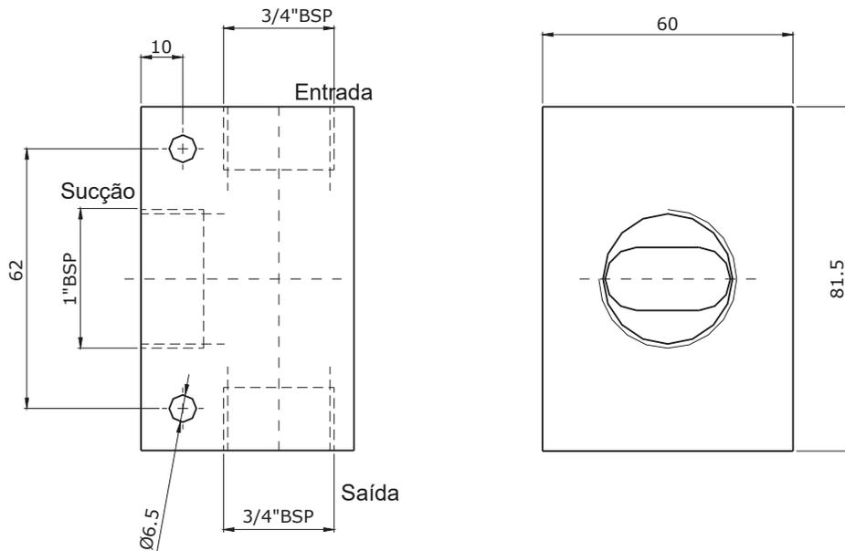
V-111S - Geradora de Vácuo com Solenóide 1/4" BSP
